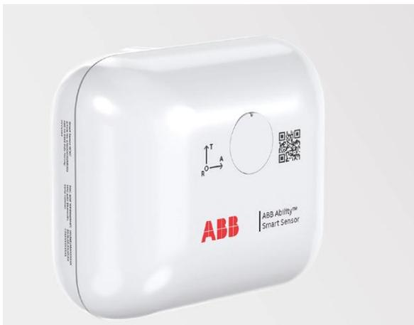
Der ATEX Smart Sensor verfügt über die neueste Sensortechnologie einschließlich Beschleunigungsmesser, Magnetometer und Ultraschall-Akustiksensoren. Selbst leichte Anomalien im Zustand der Einrichtung können in einem sehr frühen Stadium erkannt werden. Die mechanische Ausführung des Sensors erlaubt es den Messwertgebern, die tatsächlichen Maschinenvibrationen unabhängig von eventuell auftretenden Resonanzen aufzunehmen.
